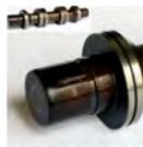
Ventilkolben mit Ablagerungen
